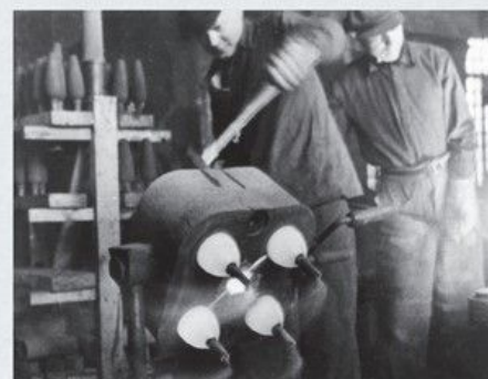
▲ Выбрана отливки 82-мм мин из кокилей в литейном цехе
